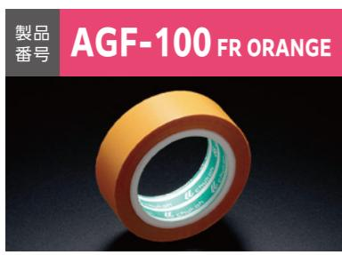
オレンジ色に着色したふつ素樹脂(PTFE)含浸ガラスクロスを基材とし、シリコーン系粘着剤を塗布した粘着テープです。ふつ素樹脂粘着テープの持つ様々な特性に加え、オレンジ色着色により電気自動車(EV)の高電圧配線識別用途に最適です。
