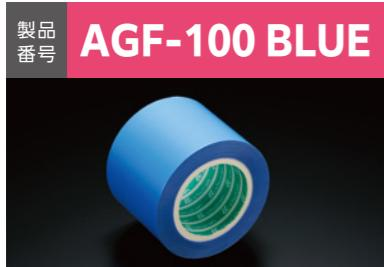
青色に着色したふつ素樹脂(PTFE)含浸ガラスクロスを基材とし、シリコーン系粘着剤を塗布した製品です。表層が青色のため、ワークとの識別性が向上し、万が一破損した場合も異物として認識されやすい製品です。
