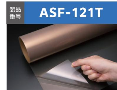
ふつ素樹脂(PTFE)フィルムを基材とし、高耐熱シリコーン系粘着剤を塗布した製品です。ASF-110FRとは異なる表面処理方法のため、灰色となっています。高温時の収縮が小さく、表面平滑性に優れています。PETセパレーター付きで、打抜き加工にも適しています。※ご要望に応じて打ち抜き、ハーフカット、カット加工も可能です。
